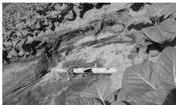
写真2 破裂した石綿セメント管
